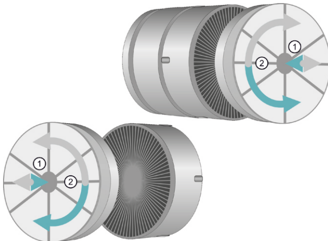
Рис. 14 Установка угольного фильтра
